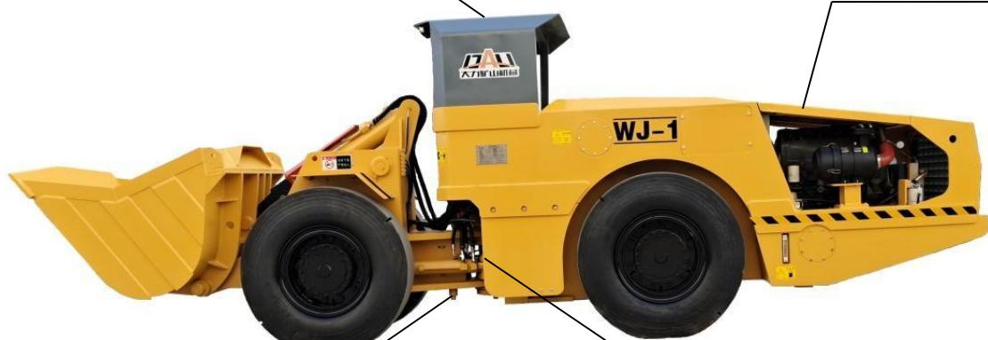
Diseño optimizado del bastidor trasero, que proporciona al conductor una excelente visibilidad durante la operación
